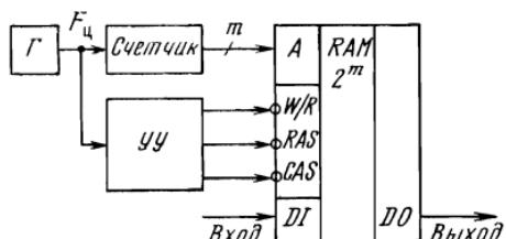
Рис. 3.15. Применение динамического ОЗУ для задержки цифровых сигналов
