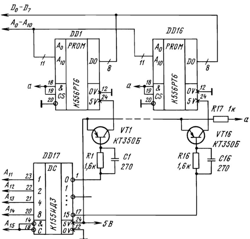
Рис. 5.11. Схема импульсного питания ПЗУ
