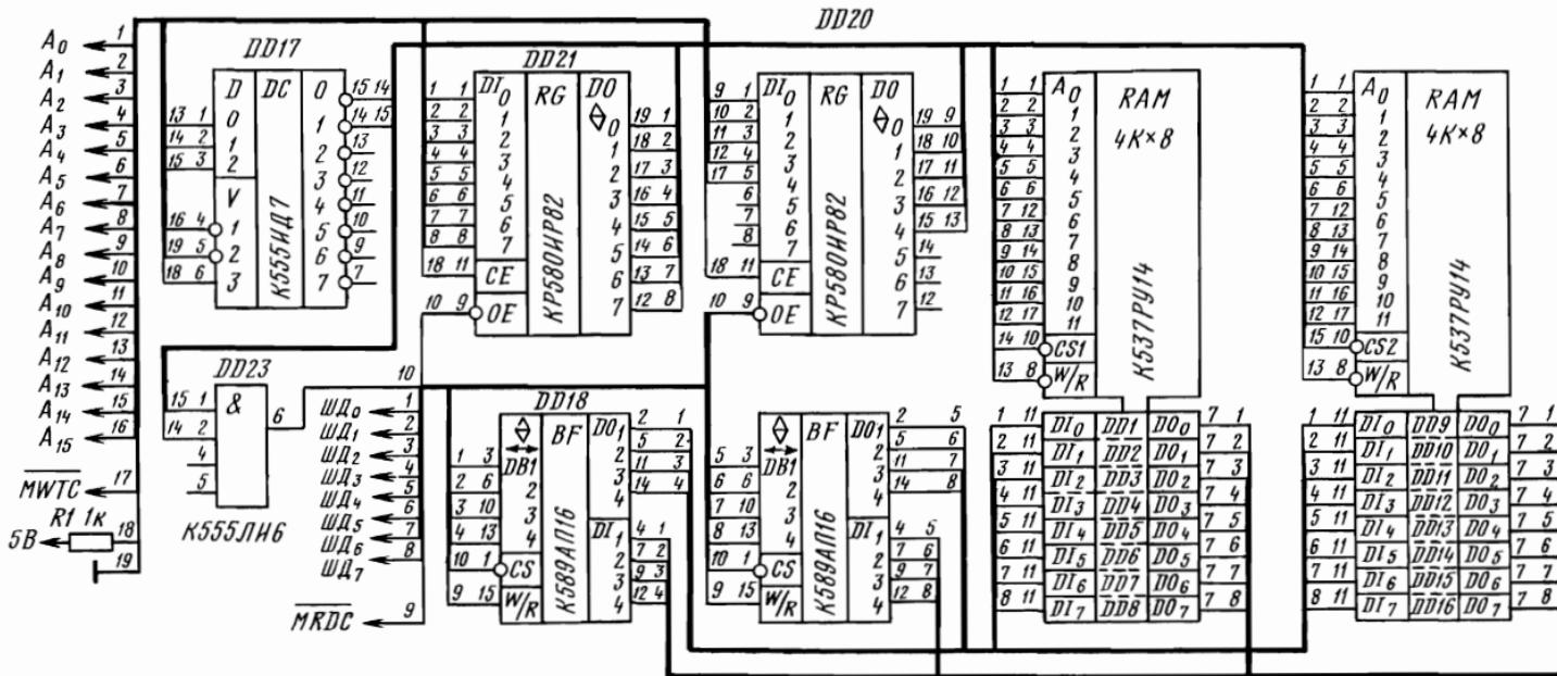
Рис. 3.1. Блок статического ОЗУ на микросхемах памяти с раздельными линиями ввода-вывода данных
