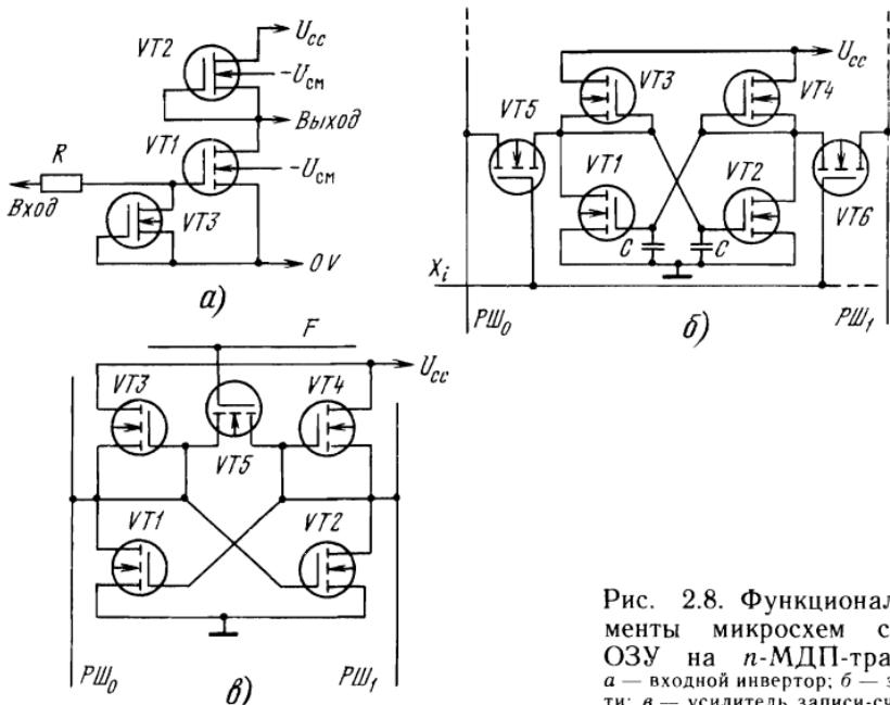
Рис. 2.8. Функциональные элементы микросхем статических ОЗУ на *n*-МДП-транзисторах:
