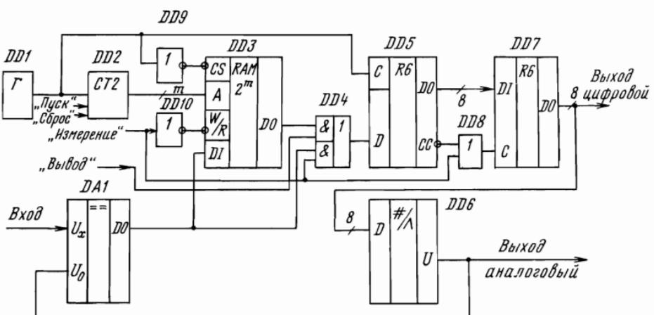
Рис. 3.17. Устройство аналого-цифрового преобразования сигналов с буферной памятью
