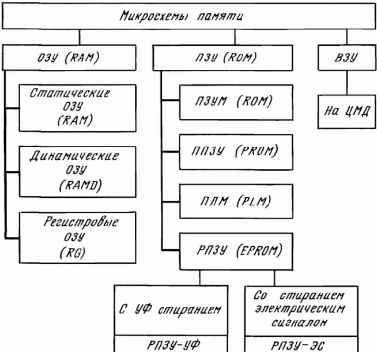
Рис. 1.4. Классификация микросхем памяти
