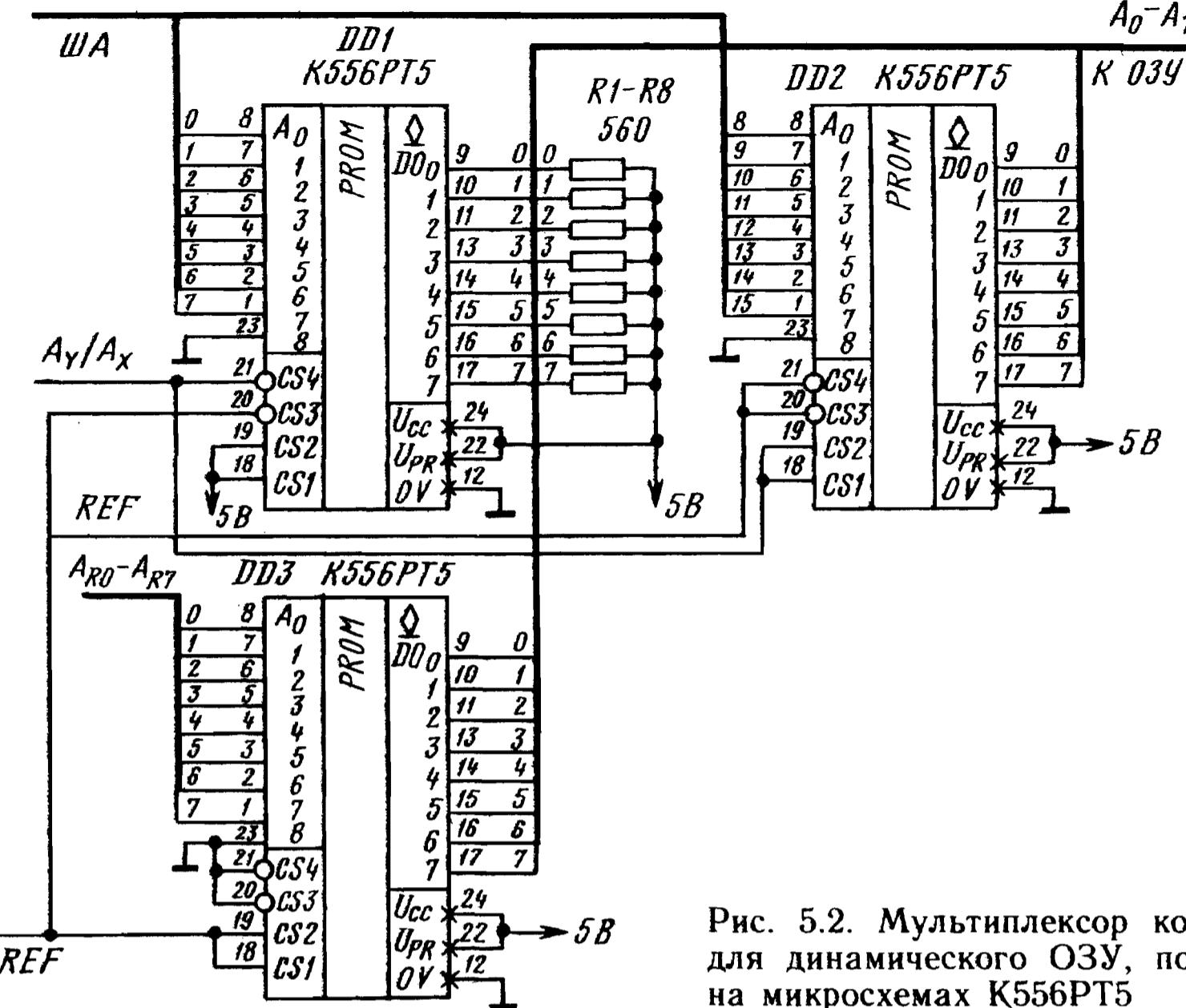
Рис. 5.2. Мультиплексор кода адреса для динамического ОЗУ, построенный на микросхемах К556ПТ5
