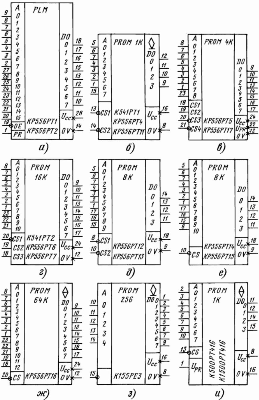
Рис. 4.4. Микросхемы ППЗУ
