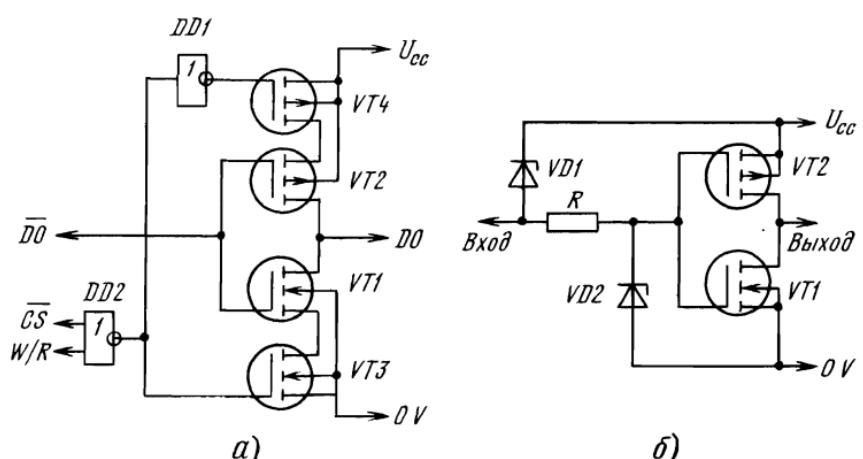
Рис. 2.3. Инверторы на КМДП-транзисторах:
