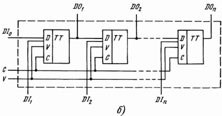
Рис. 1.3. Функциональные схемы регистров хранения (а), сдвига (б)
