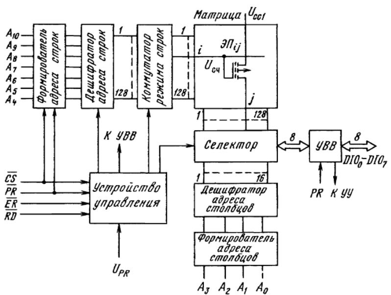
Рис. 4.10. Структура микросхемы РПЗУ-ЭС
