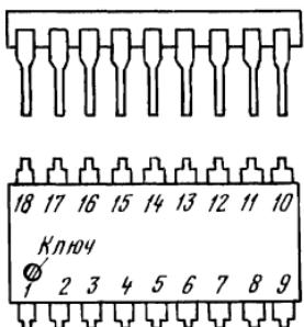
Рис. 1.11. Корпус типа 2
