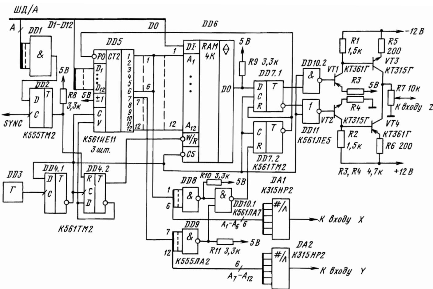
Рис. 3.19. Устройство вывода информации с магистрали МПИ на экран осциллографа
