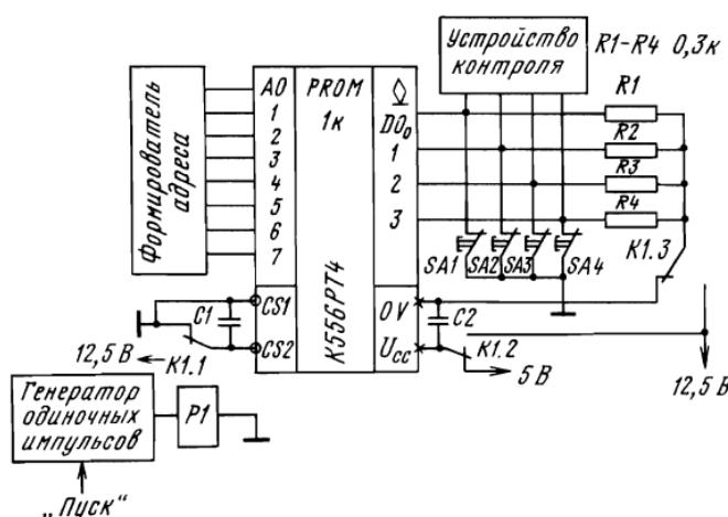
Рис. 5.7. Простейший программатор микросхем ППЗУ
