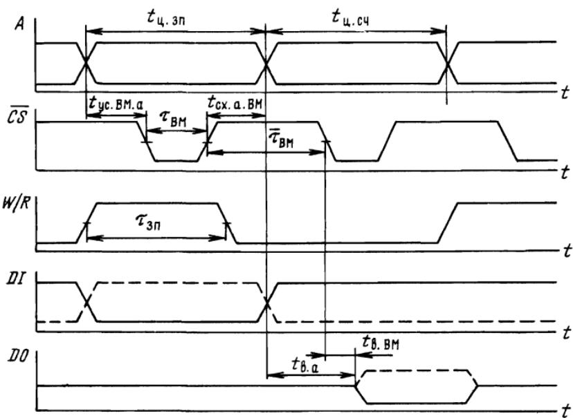
Рис. 1.9. Временные диаграммы микросхемы статического ОЗУ
