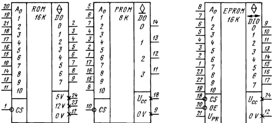
Рис. 1.6. Условные графические изображения микросхем ПЗУМ (а), ППЗУ (б)
