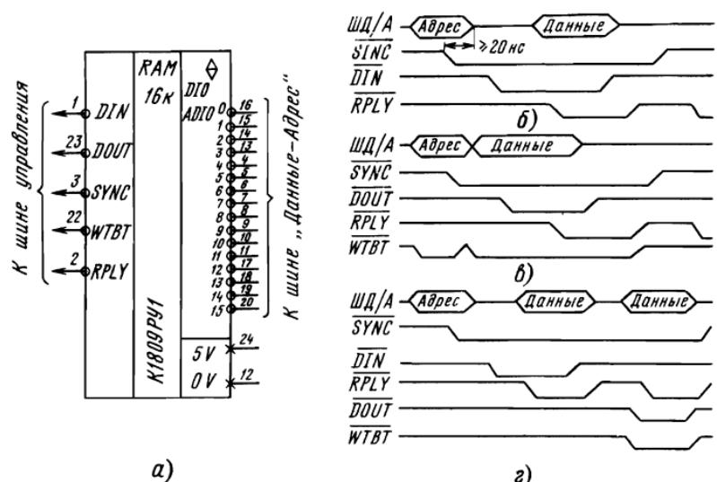
Рис. 3.7. Микросхема статического ОЗУ K1809РУ1 емкостью  $1K \times 6$  бит:
