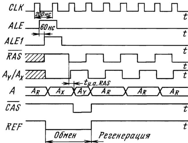
Рис. 3.14. Временные диаграммы сигналов управления динамическим ОЗУ (рис. 3.12)
