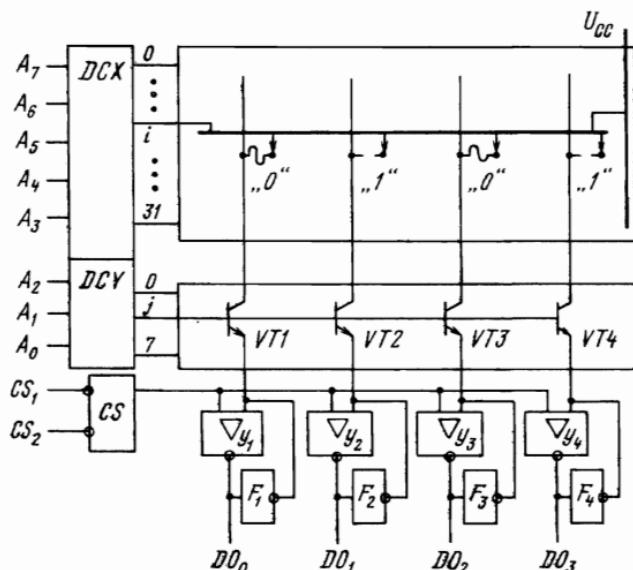
Рис. 4.5. Устройство микросхемы ППЗУ
