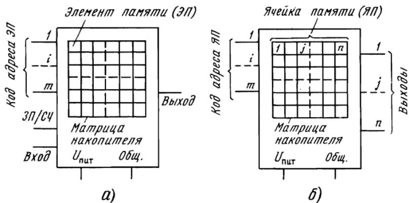
Рис. 1.2. Микросхема памяти как функциональный узел:
