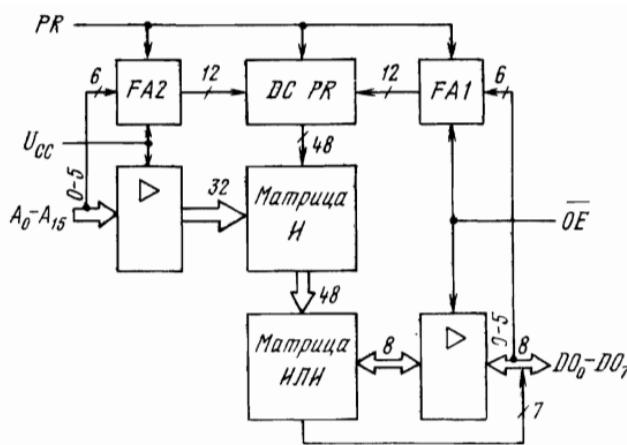
Рис. 4.6. Структура микросхемы ПЛМ
