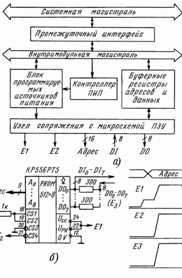
Рис. 5.9. Устройство автоматического программирования микросхем ППЗУ, РПЗУ:
