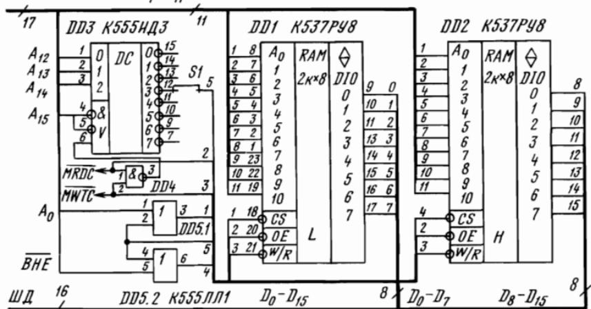
Рис. 3.3. Блок статического ОЗУ с интерфейсом И41 на микросхемах памяти с байтовой организацией
