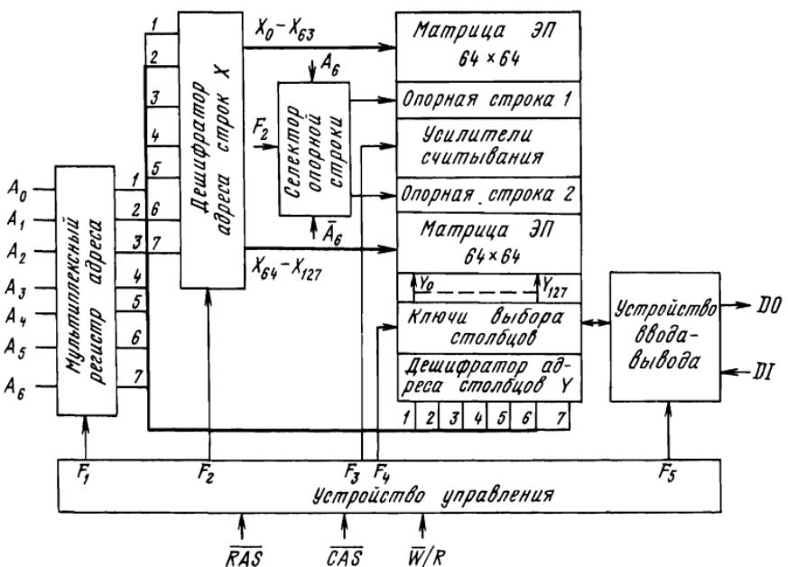
Рис. 2.13. Структура микросхемы динамического ОЗУ
