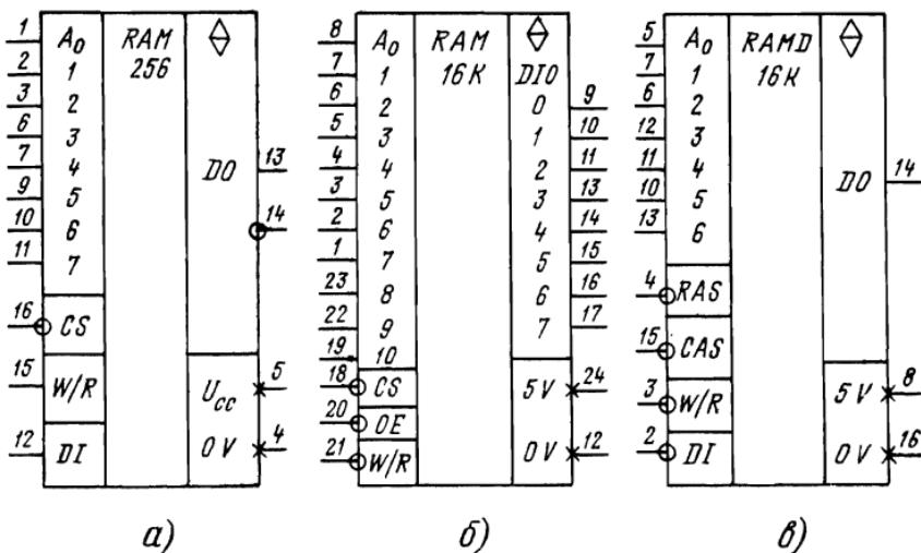
Рис. 1.5. Условные графические изображения микросхем ОЗУ:
