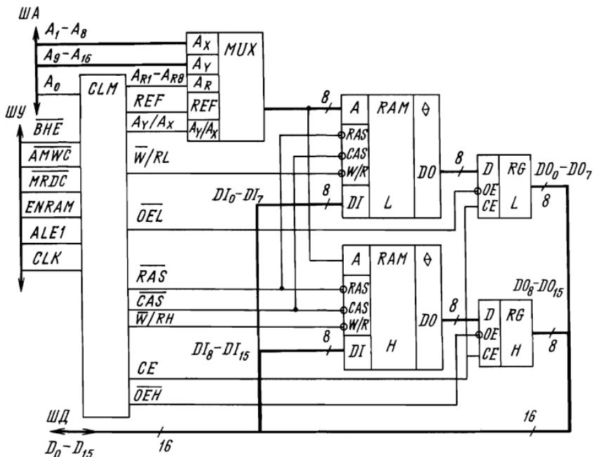
Рис. 3.12. Блок динамического ОЗУ с интерфейсом И41
