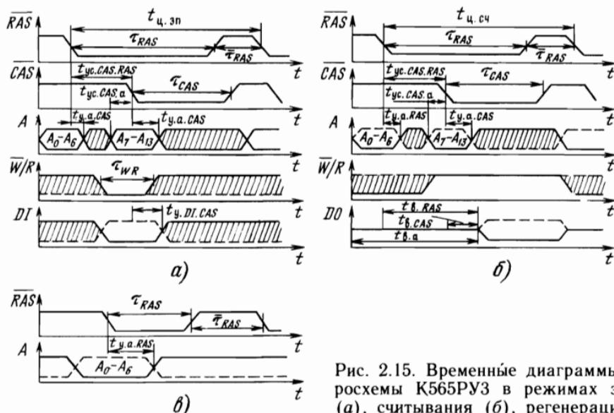
Рис. 2.15. Временные диаграммы микросхемы К565РУ3 в режимах записи (а), считывания (б), регенерации (в)
