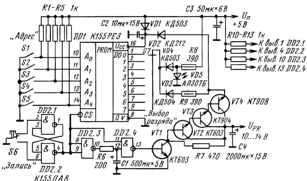
Рис. 5.8. Принципиальная схема программатора микросхем ППЗУ
