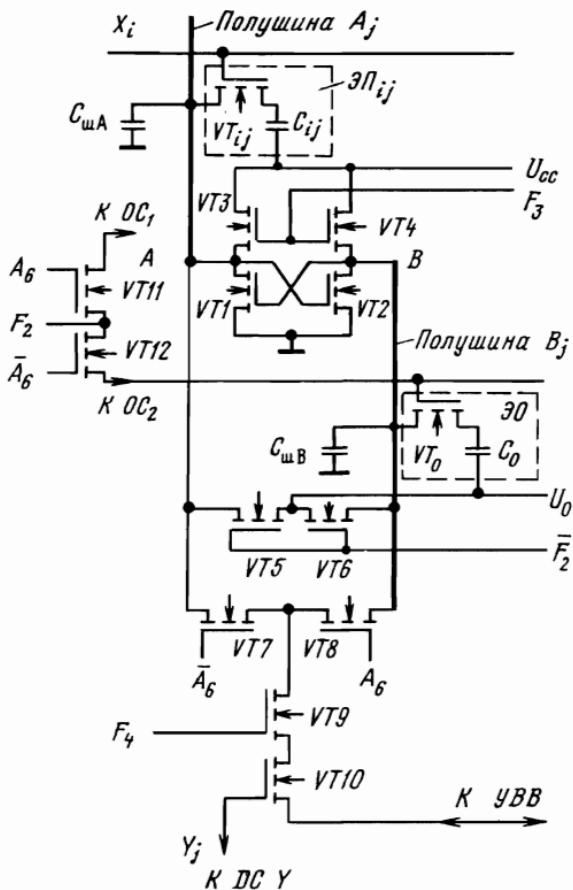
ключевые транзисторы VT7, VT9 и VT10, открываемые сигналами  $A_6$ ,  $F_4$  и  $Y_j$ . Очевидно, считан может быть только один сигнал с выбранного дешифратором столбца:  $Y_j = 1$ . У остальных столбцов ключи VT10 закрыты. Сигнал  $F_4$  зависит от наличия сигнала CAS: при отсутствии последнего он не формируется и ключ VT9 закрыт.
