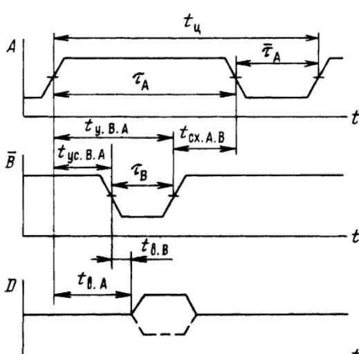
Рис. 1.8. Временные параметры микросхем памяти
