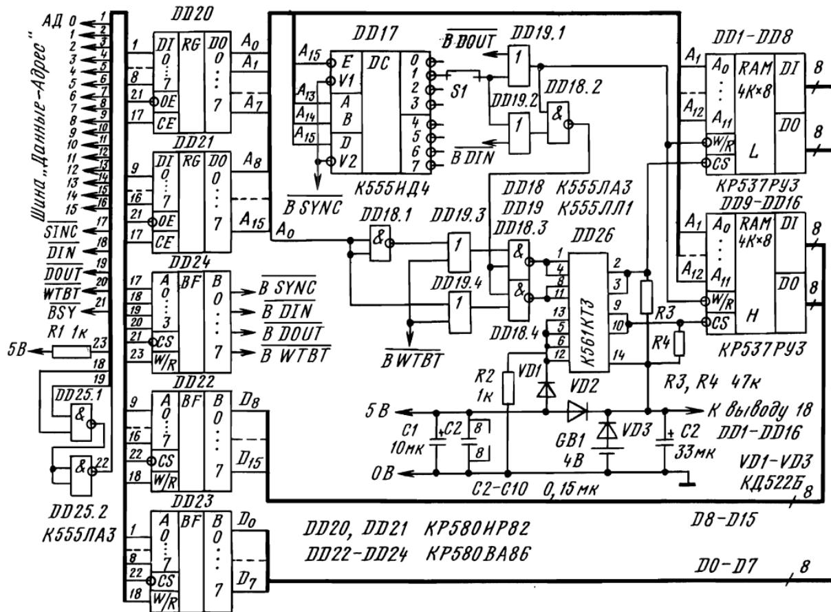
Рис. 3.5. Блок статического ОЗУ с интерфейсом МПИ
