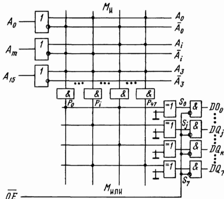
Рис. 4.7. Функциональная схема ПЛМ
