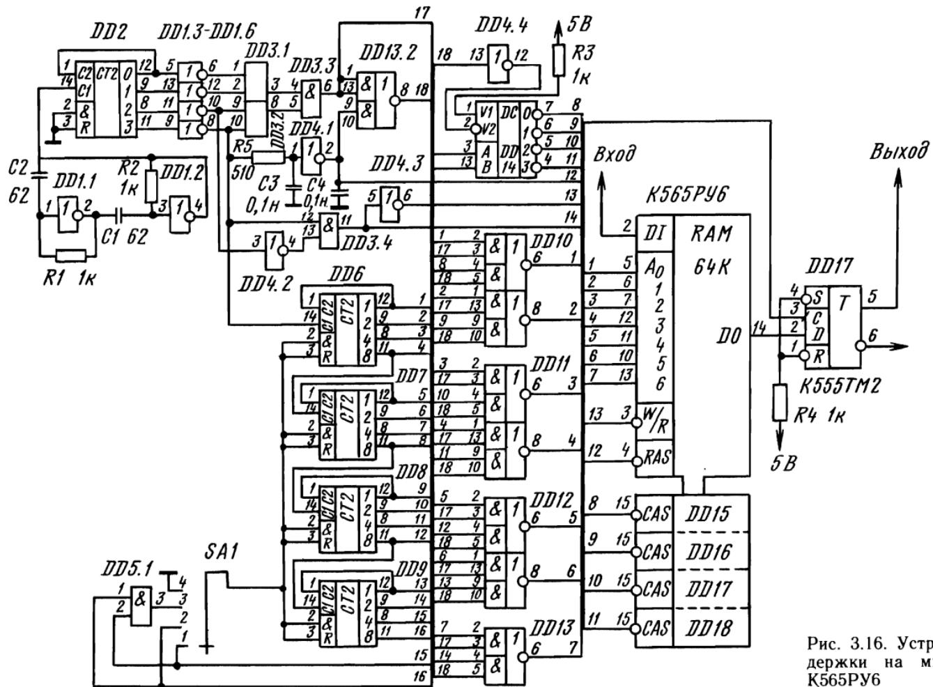
Рис. 3.16. Устройство задержки на микросхемах K565PY6
