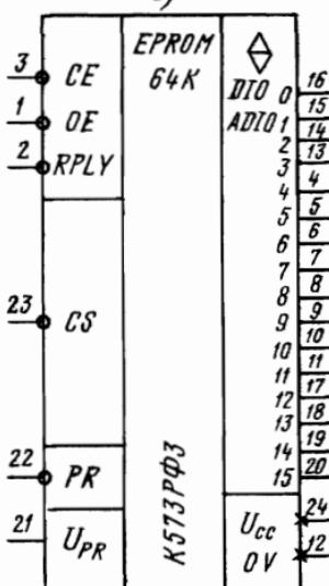
Рис. 4.8. Микросхемы РПЗУ
