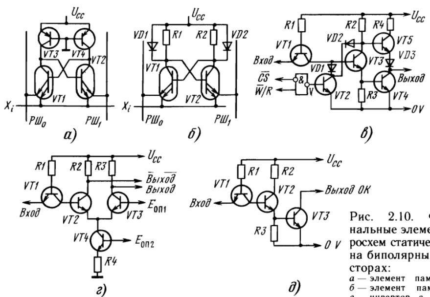
Рис. 2.10. Функциональные элементы микросхем статических ОЗУ на биполярных транзисторах:
