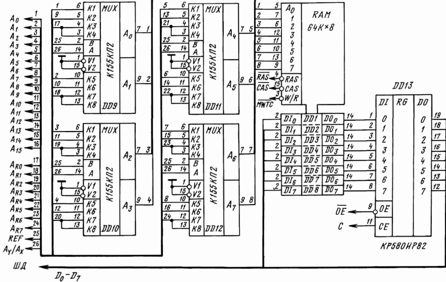
Рис. 3.9. Блок динамического ОЗУ с мультиплексором кода адреса
