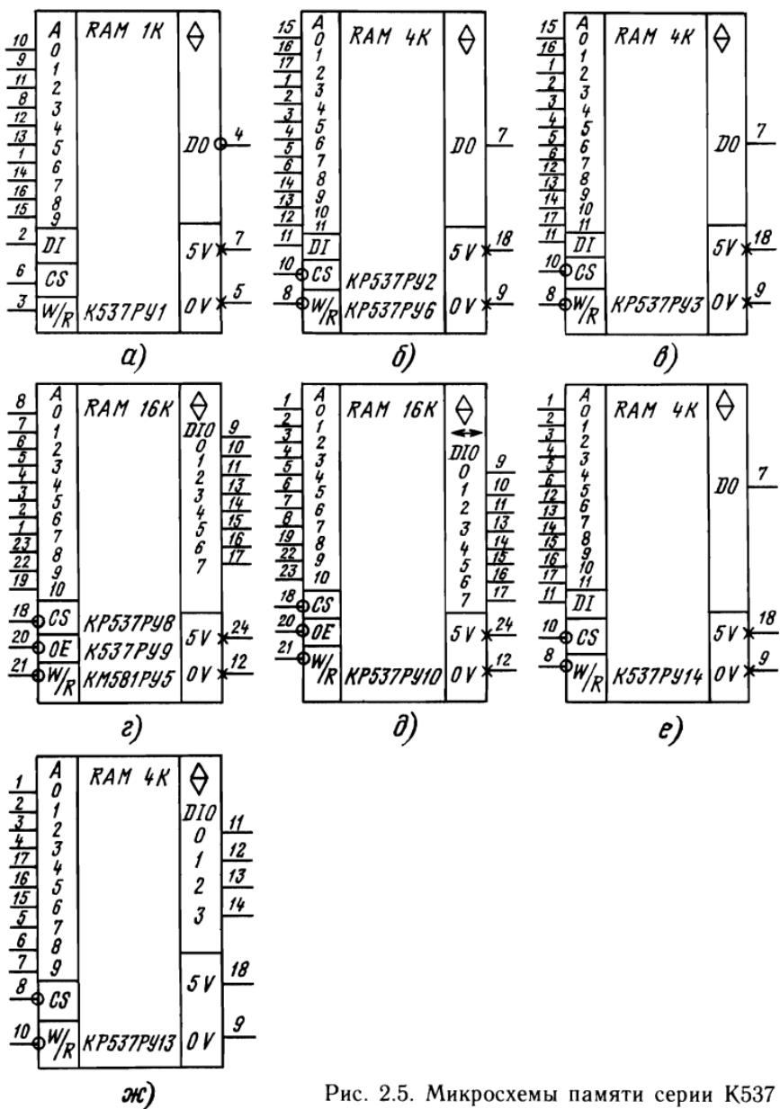
Рис. 2.5. Микросхемы памяти серии K537
