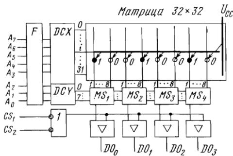
Рис. 4.1. Устройство микросхемы макетного ПЗУ на биполярных структурах
