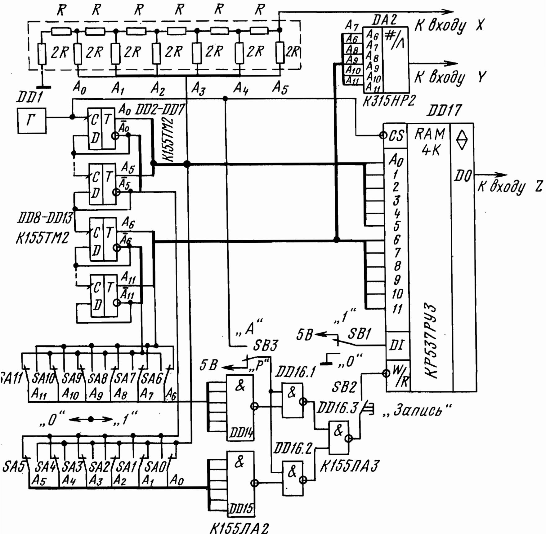
Рис. 3.18. Устройство для записи, хранения кодовых последовательностей и вывода их на экран осциллографа
