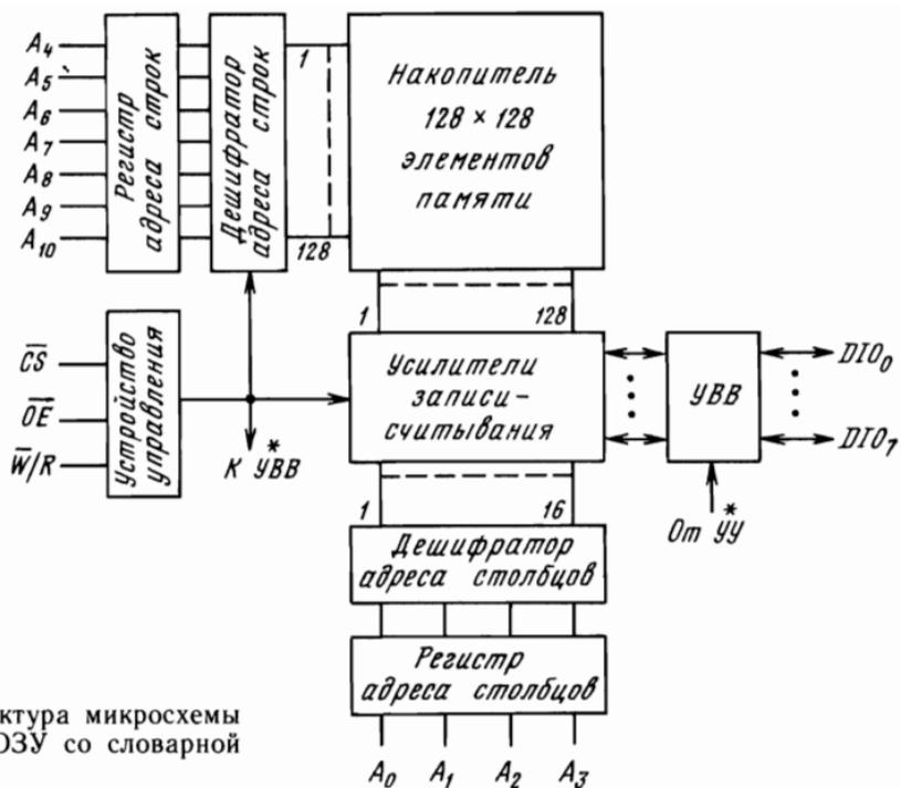
Рис. 2.4. Структура микросхемы статического ОЗУ со словарной организацией
